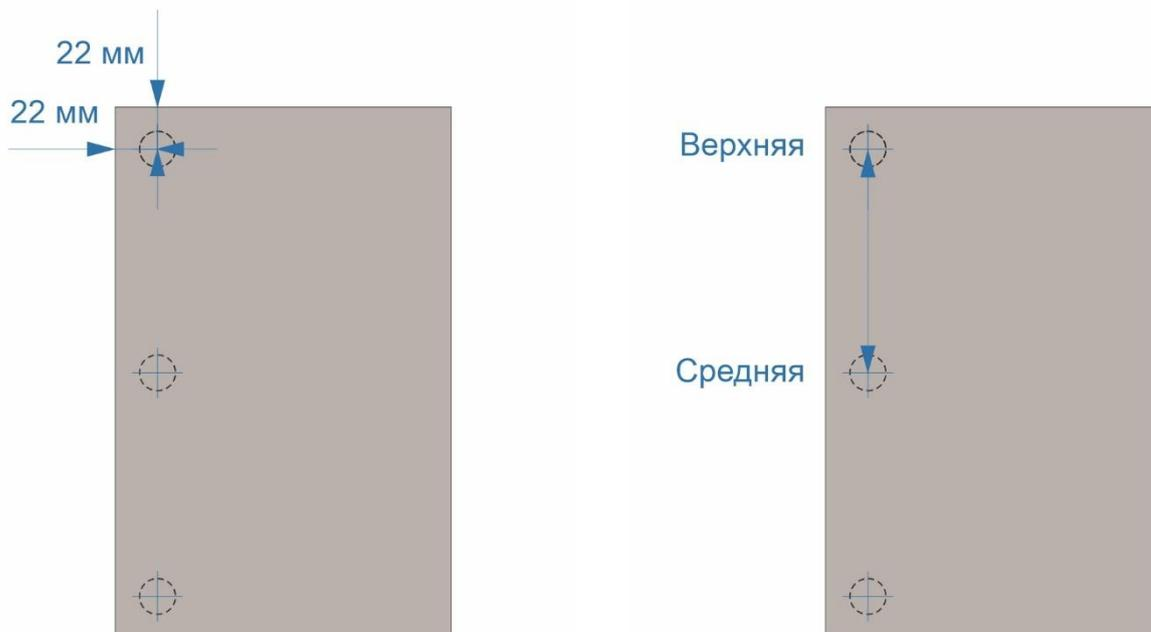
Чтобы определить расстояние до центра средней петли, нужно измерить вертикальный промежуток между центрами петель.
